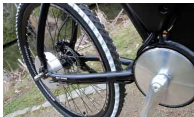
Verzichtet vollkommen auf die mechanische Kraftübertragung mittels Kette: Das »Pedelec« oder »E-Bike«.
